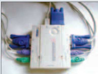
Переключатель. Делит мышь, клавиатуру и монитор между двумя компами. Рекомендую покупать вместе с проводами, потому что там особые разъемы под монитор
